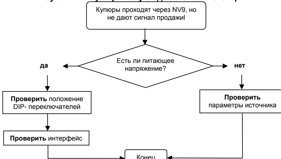
Рисунок 15 – Купюра проходит через NV9, но не выдает сигнал продажи
